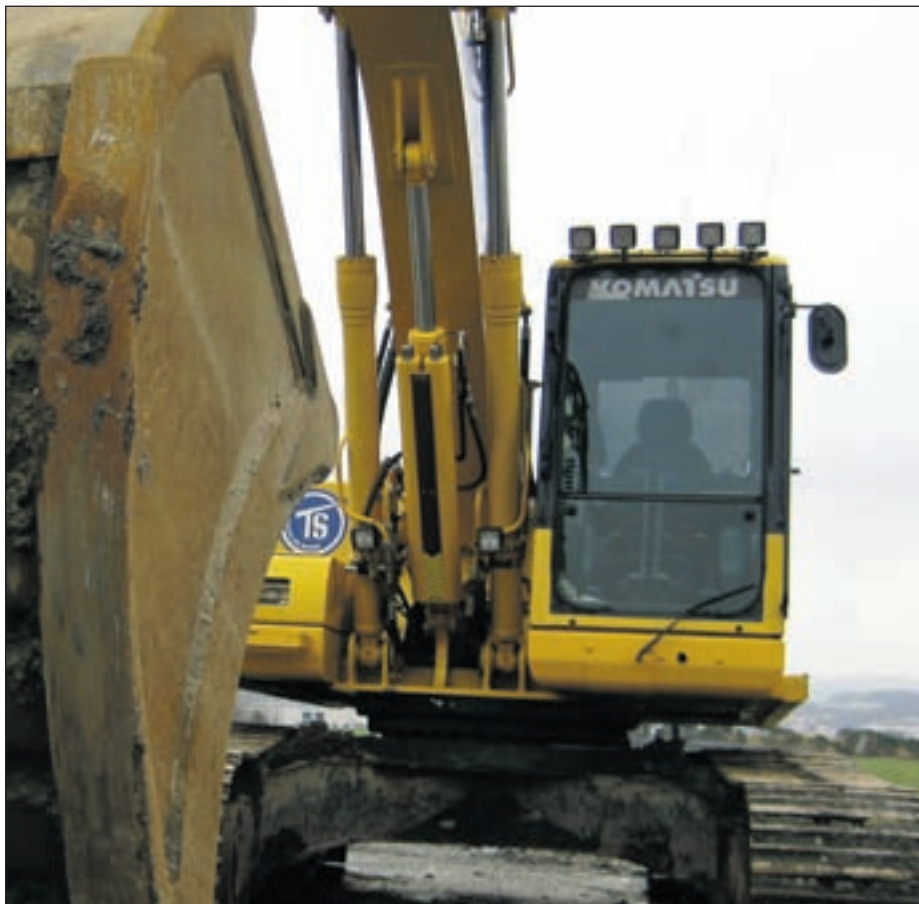
Her Acculinder EPC System påmontert en Komatsu gravemaskin.
